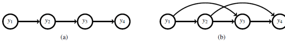
شکل ۲- شکل سمت چپ (a) - شبکه بیزین ۱ متناظر با مدل مارکوف مرتبه اول که در آن هر گام زمانی تنها به یک گام گذشته وابسته است. شکل سمت راست (b) - شبکه بیزین متناظر با مدل مارکوف مرتبه دو که در آن هر گام زمانی به دو گام زمانی قبل از خود وابسته است. [۱۸]
