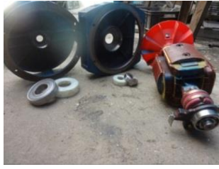
شکل ۹: نحوه عایق سازی یاتاقانهای ژنراتور
