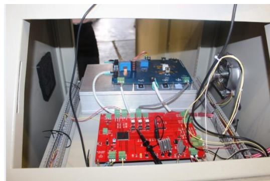
شکل ۱۴: برد کنترلی طراحی شده برای پیاده‌سازی بلوک دیاگرام شکل ۹
