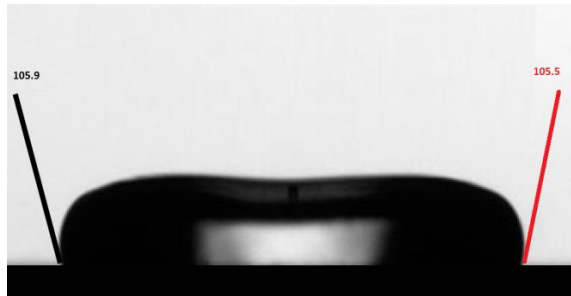
شکل ۸ تصویر برخورد قطره گلیسرین با سطح استیل [۱۲]
