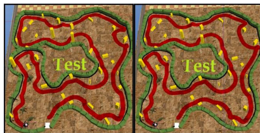
شکل ۱۱: نمایی از خط سیر ربات در هدایت توسط کنترلگر DIDF-
