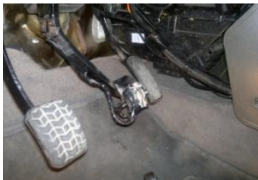
شکل ۱۹: نیروسنج نصب شده بر روی پدال ترمز
