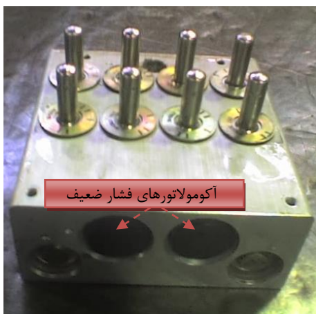
شکل ۹: بخش هیدرولیک بلوک ترمز ضد قفل
