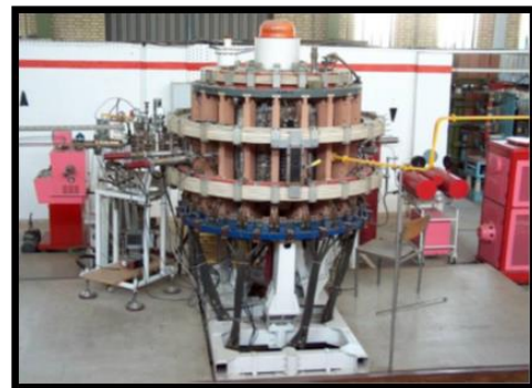
شکل ۲: نمایی از محفظه و سیم پیچهای توکامک دماوند
