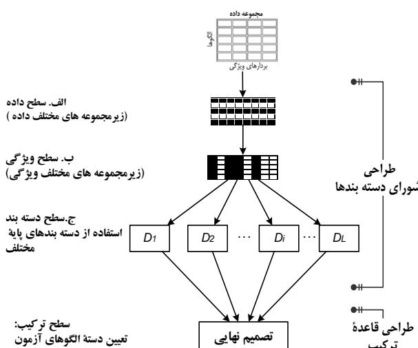
شکل ۱. ساختار سیستمهای دسته‌بند چندگانه (شورایی)
