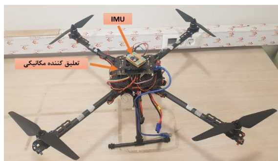
شکل ۴: نمایی از ربات کوادکوپتر استفاده شده در آزمایشات عملی
