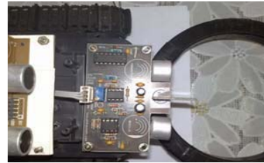
شکل ۴- نمایی از مدار فاصله سنج و تشخیص موانع ربات ونوس
