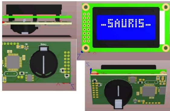
شکل ۶۱: مدار الکترونیکی جهت قرائت خازنی
