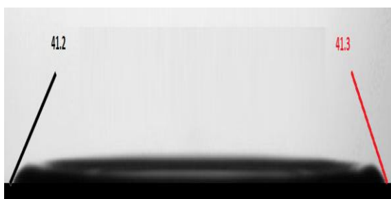
شکل ۷ تصویر برخورد قطره اتانول با سطح استیل [۱۲]
