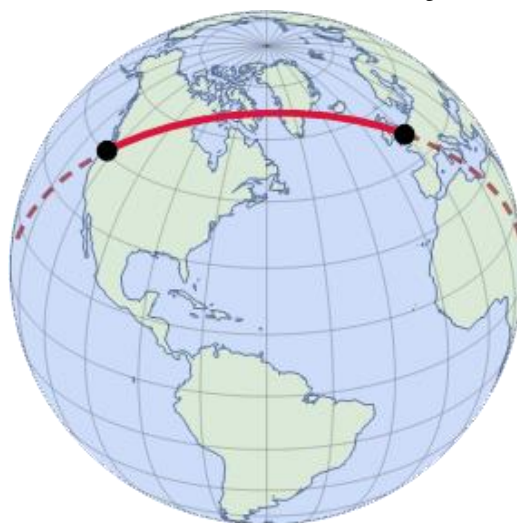
شکل ۳- مفهوم دایره بزرگ در هاورسین [۸و۶] معادلات هاورسین از دستگاه مختصات کروی استفاده می‌کند که دارای ویژگی‌های زیر است:
