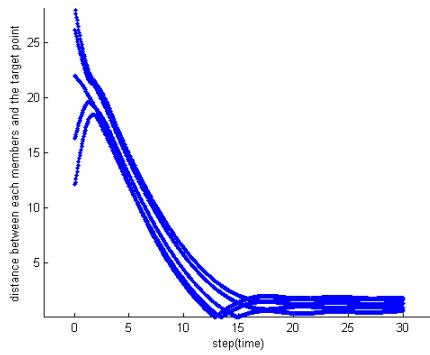
شکل ۳: شبیه‌سازی حرکت توده در محیط بدون مانع در صورت تمايل به تجمع
