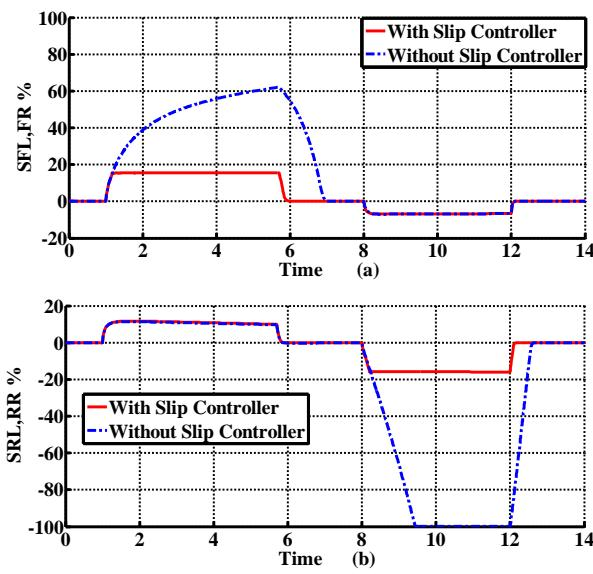
شکل ۸: (a) درصد لغزش چرخ‌های جلو. (b) درص لغزش چرخ‌های عقب
