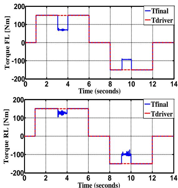
شکل ۱۴: گشتاور ورودی راننده و گشتاور نهایی موتورهای الکتریکی نصب شده در چرخ‌ها با وجود کنترل لغزش
