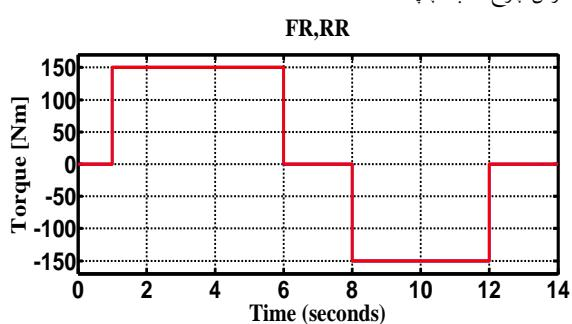
شکل ۱۳: گشتاور ورودی راننده که به دلیل لغزش کم چرخها، کنترل لغزش در آن مداخله ای نمی کند و باستی توسط موتورهای چرخهای سمت راست خودرو تامین گردد
