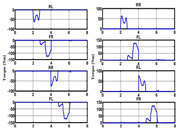
شکل ۲۸: نحوه توزیع گشتاور خروجی کنترل ESC فازی نوع ۲ به موتورهای واقع شده در چرخ‌ها که تصاویر سمت راست مربوط به گشتاور شتاب گیری وارد بر چرخ‌ها و تصاویر سمت چپ مربوط به گشتاور ترمزگیری وارد بر چرخ‌ها می‌باشد.
