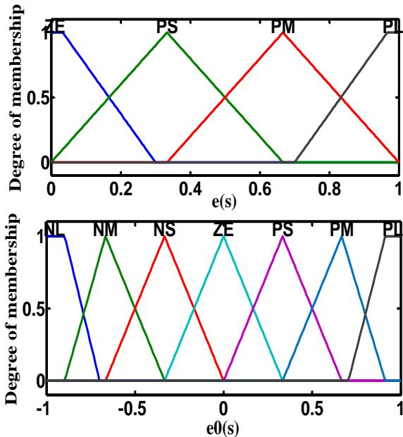
شکل ۵: توابع عضویت متغیرهای ورودی
