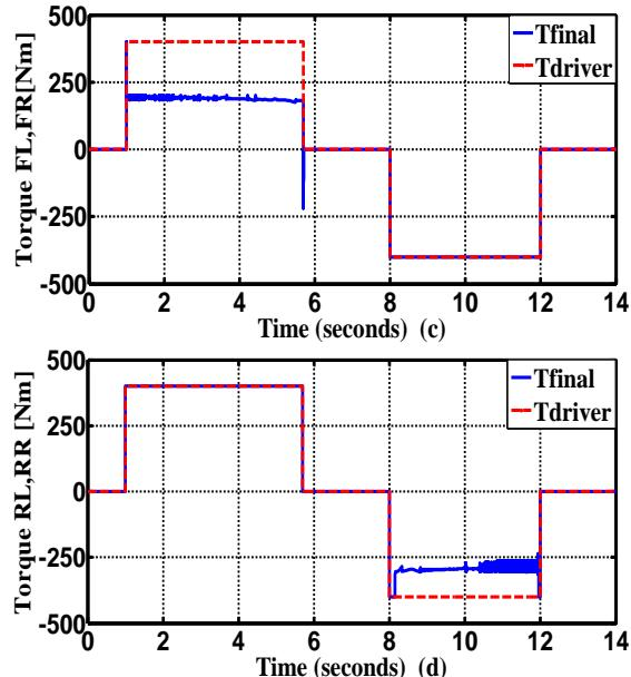
شکل ۱۰: تصاویر (c) و (d) به ترتیب مربوط به گشتاور موتور چرخهای جلو و عقب می باشد. در تصاویر بالا منحنی قرمز مربوط به گشتاور ورودی توسط راننده و منحنی آبی مربوط به گشتاور نهایی با وجود کنترل کننده لغزش است که می بایست توسط موتورهای الکتریکی تامین شود.
