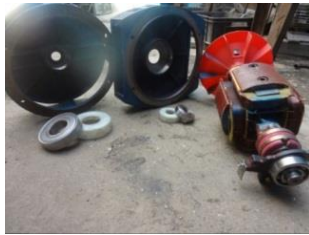
شکل ۹: نحوه عایق سازی یاتاقانهای ژنراتور
