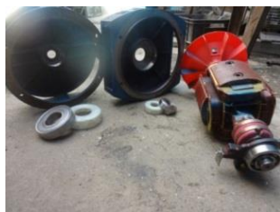
شکل ۹: نحوه عایق سازی یاتاقانهای ژنراتور
