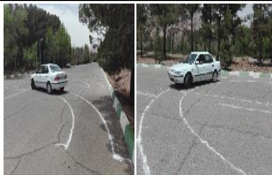
شکل ۱: آزمایشات عملی دورزدن تک‌فرمان با خودروی سمند
