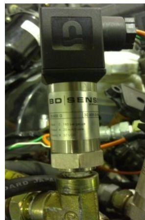
شکل ۱۶: سنسور فشارسنج هیدرولیک
