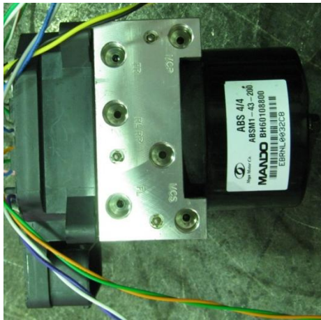
شکل ۸: بلوک الکترو هیدرولیک یا مدولاتور ترمز ضد قفل
