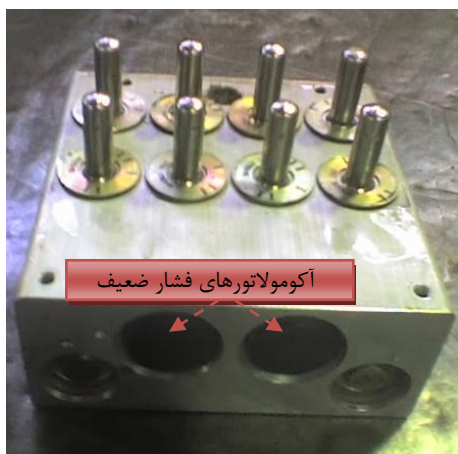
شکل ۹: بخش هیدرولیک بلوک ترمز ضد قفل
