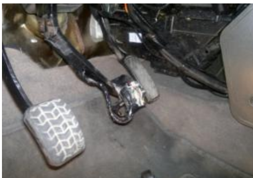
شکل ۱۹: نیروسنج نصب شده بر روی پدال ترمز
