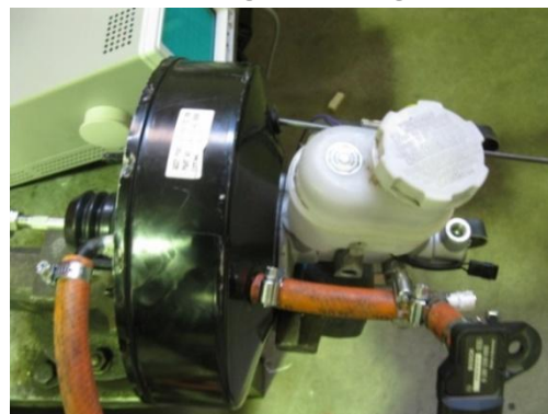
شکل ۱۸: بوستر ترمز مجهز به ادوات اندازه گیری
