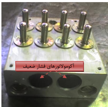
شکل ۹: بخش هیدرولیک بلوک ترمز ضد قفل
