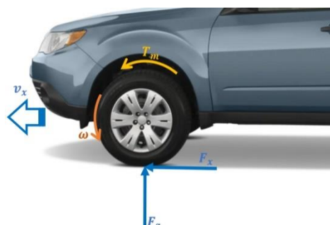
شکل ۱: دیاگرام جسم آزاد مدل یک چهارم خودرو در فرآیند شتاب‌گیری
