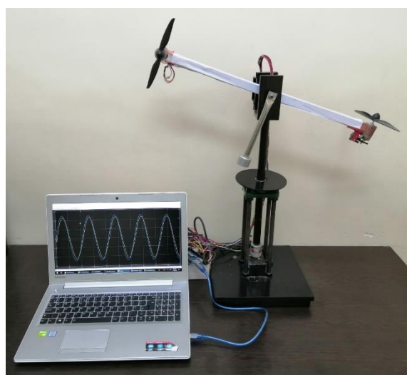
شکل ۲: ساخت سیستم واقعی TRMS در محیط آزمایشگاهی
