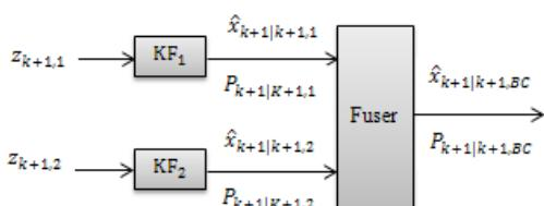
شکل ۱: ترکیب بردار حالت با استفاده از روابط BC برای تعداد ۲ حسگر معرف فیلتر کالمن می باشد.
