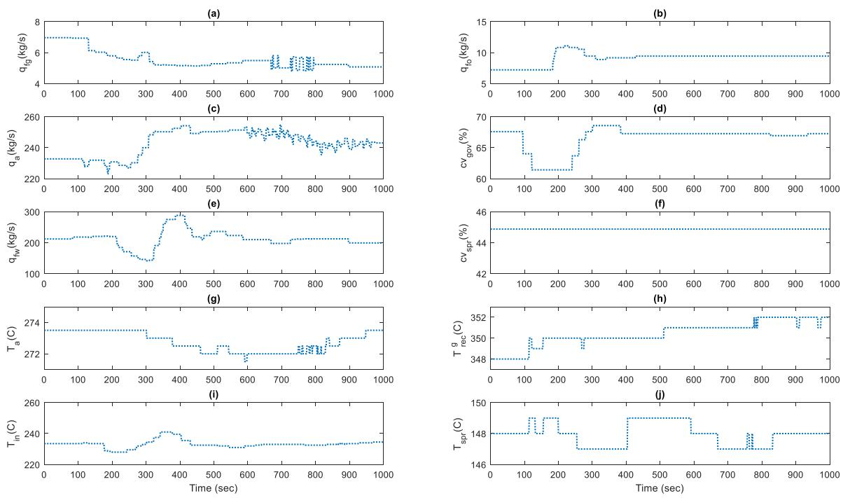
شکل ۶: متغیرهای ورودی کنترلی و انتشار در زمان حادثه کمبود سوخت
