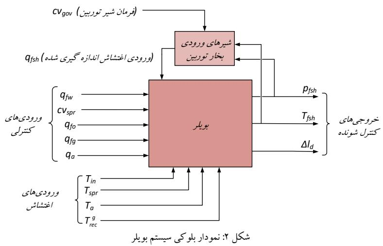
شکل ۲: نمودار بلوکی سیستم بویلر
