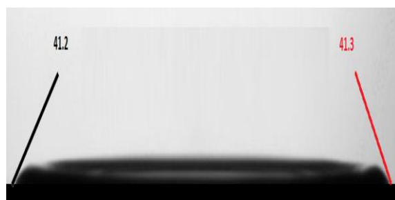
شکل ۷ تصویر برخورد قطره اتانول با سطح استیل [۱۲]
