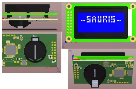
شکل ۶۱: مدار الکترونیکی جهت قرائت خازنی
