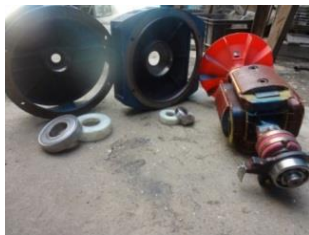
شکل ۹: نحوه عایق سازی یاتاقانهای ژنراتور
